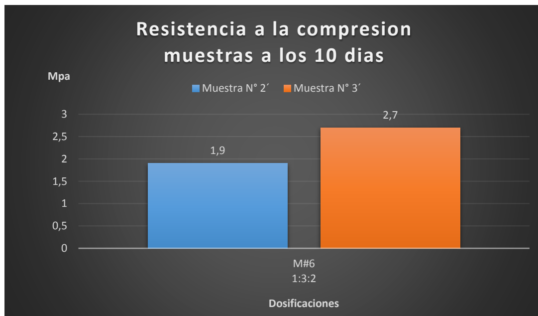
Grafico 8. Resumen de la resistencia a la compresión simple a muestras a los 10 días de edad con dosificación 1:3:2
