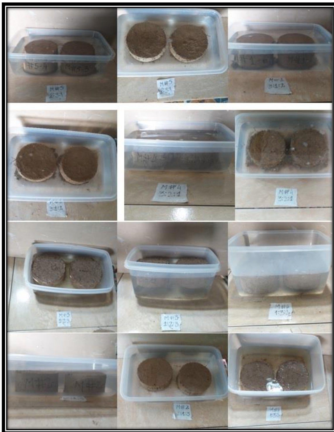
Ensayo de absorción. Fuente: elaboración propia
