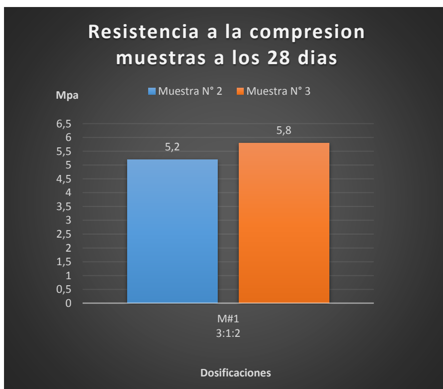
Grafico 9. Resumen de la resistencia a la compresión simple a muestras a los 28 días de edad con dosificación 3:1:2
