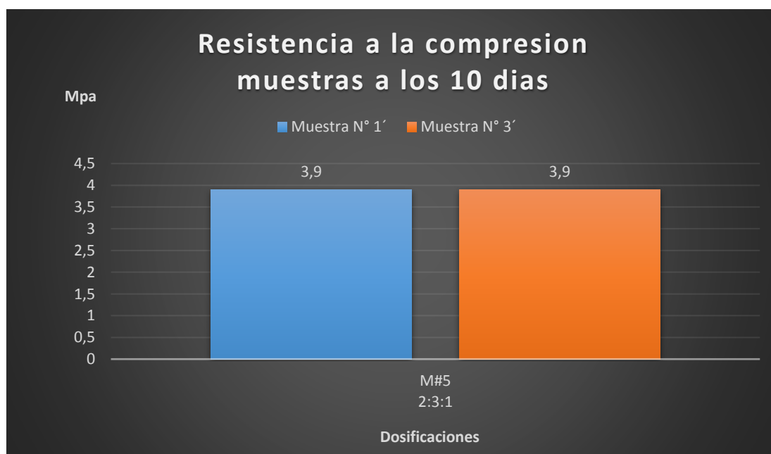
Grafico 7. Resumen de la resistencia a la compresión simple a muestras a los 10 días de edad con dosificación 2:3:1
