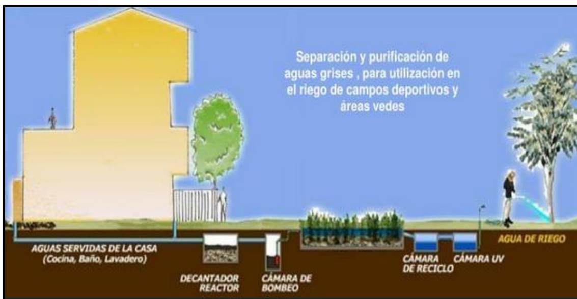
Esquema de purificación de aguas grises, aplicado en riego.
