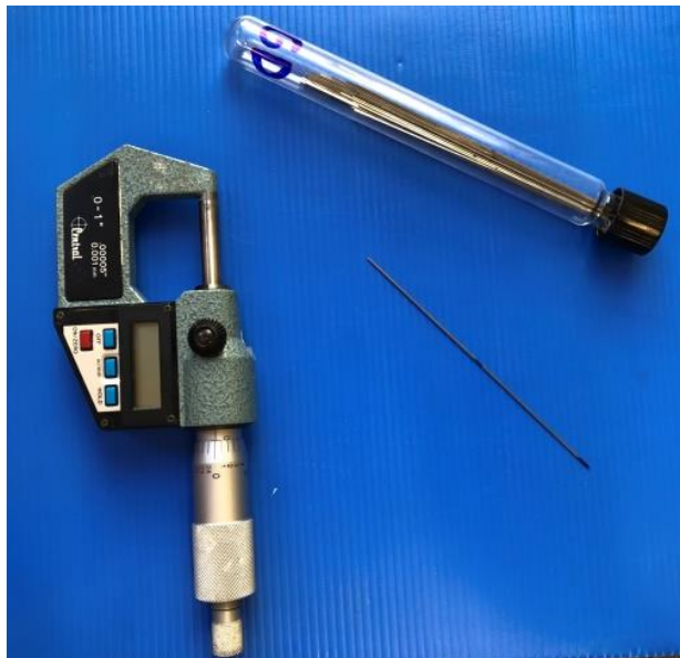
Figura 2: sección de alambre y calibrador.
