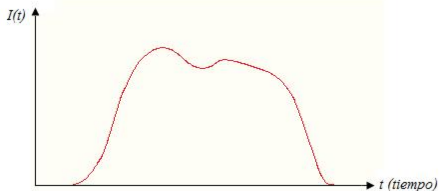
Figura 3.7: Pulso enviado por el marcapasos hacia el corazón.
