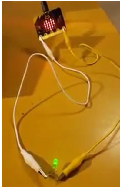
Figura N° 63. Video encendido de LED. Uso de pines y cables cocodrilo. Elaboración propia. https://drive.google.com/file/d/12Vyt6xn-s448Xjlvbc0aOe-O1V6w_tq3/view
