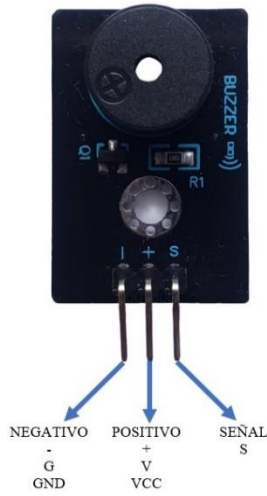
Figura N° 20. Imagen de la conexión de pines en componentes genéricos. Elaboración propia.
