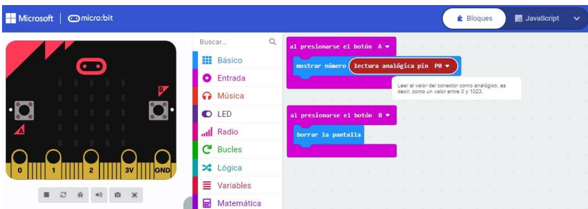
Figura N° 37. Imagen de un ejemplo de la programación con lectura de pines analógicos. Elaboración propia.
