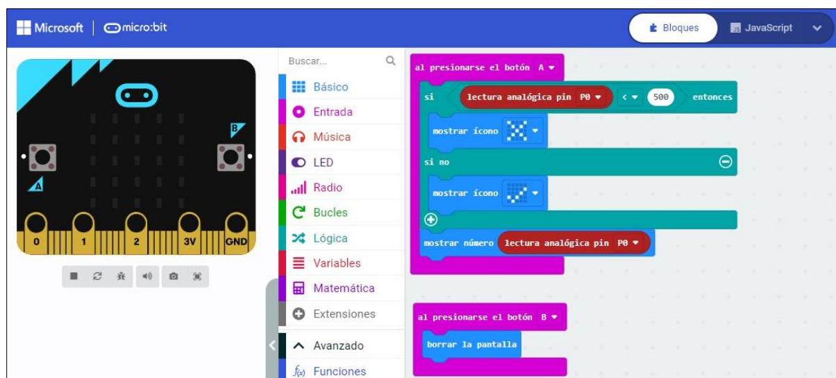
Figura N° 38. Imagen de un ejemplo de la programación con lectura de pines analógicos y condiciones. Elaboración propia.
