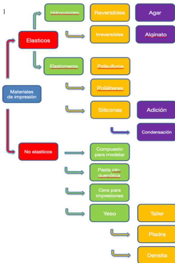
Figura 2: Clasificación de materiales de impresión
