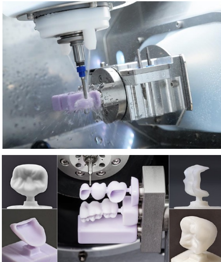
Figura 53: Representación gráfica del funcionamiento de una impresora con sistema sustractivo (fresadora)
