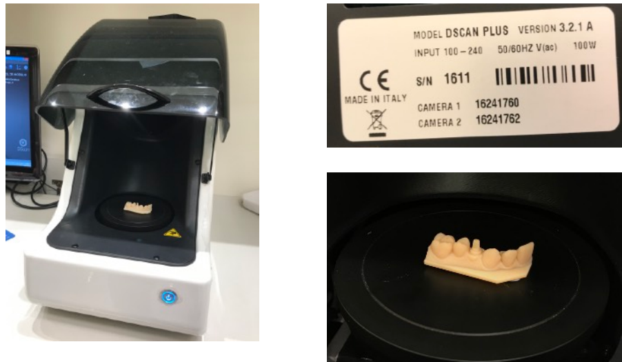
Figura 24: Escáner EGSolutions DScan 3 y detalle del numero de serie y la plataforma de escaneo respectivamente
