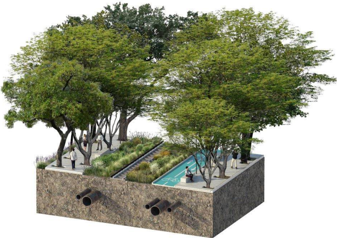
Fuente: planificación del paisaje _ módulo regional _ 2021_ arq. CEPA FRAGA María Paula - Ing. GEMMA Josefina - arq. TARZIA Gimena *con el fin de agilizar el drenaje, cada capa inferior debe tener mayor conductividad hidráulica respecto a aquellas superiores.
