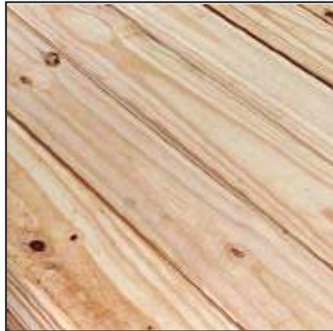
13 MACHIMBRE PINO ELLIOTIS Terminación: Laca poliuretánica Dimensiones: 5"x 1/2" / largo 2.40 m Tratamiento: Impregnado CCA ubicación: cubierta
