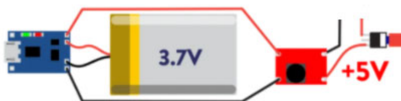
Figura 4. Esquema de conexionado Batería LiPo 3,7V - Booster DC - Módulo de carga USB
