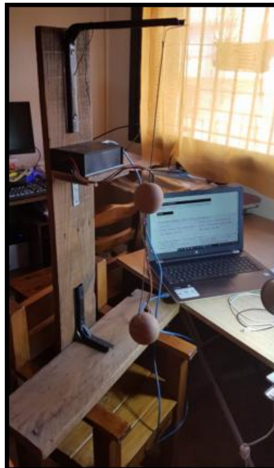
Figura 4.1: Construcción de un péndulo doble.
